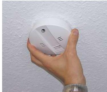
Rauchmelder sind ungefähr handgroße Geräte, die problemlos montiert werden können. Die meisten arbeiten nach dem Streulichtprinzip. Bei einer bestimmten Rauchdichte wird ein Lichtstrahl im Gerät auf eine Fozelle gelenkt und löst den akustischen Alarm aus. Für Gehörlose gibt es die Möglichkeit der Warnung durch ein Blitzlicht und Vibrationsgeber.
